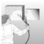
Als nächstes Firetex® Concrete WB, wie auf Seite 5 beschrieben, auf die vorgesehene Testfläche und die Stahlplatte in einem Arbeitsgang applizieren.
