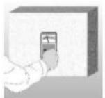
Wenn die Brandschutzbeschichtung vollständig trocken ist, kann die Schichtdicke mit dem dafür vorgesehenen Schichtdickenmessgerät ermittelt werden. Um die genauen Positionen der Aluminiumstücke zu erkennen, dient der in Schritt 3 ausgeführte Lageplan.
