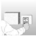
Wenn die Brandschutzbeschichtung „fingernagelhart“ getrocknet ist, kann die Trockenschichtdicke mit dem dafür vorgesehenen Schichtdickenmessgerät auf der Stahlplatte gemessen werden.
