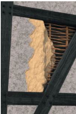
① Entfernen der Altausfachung
